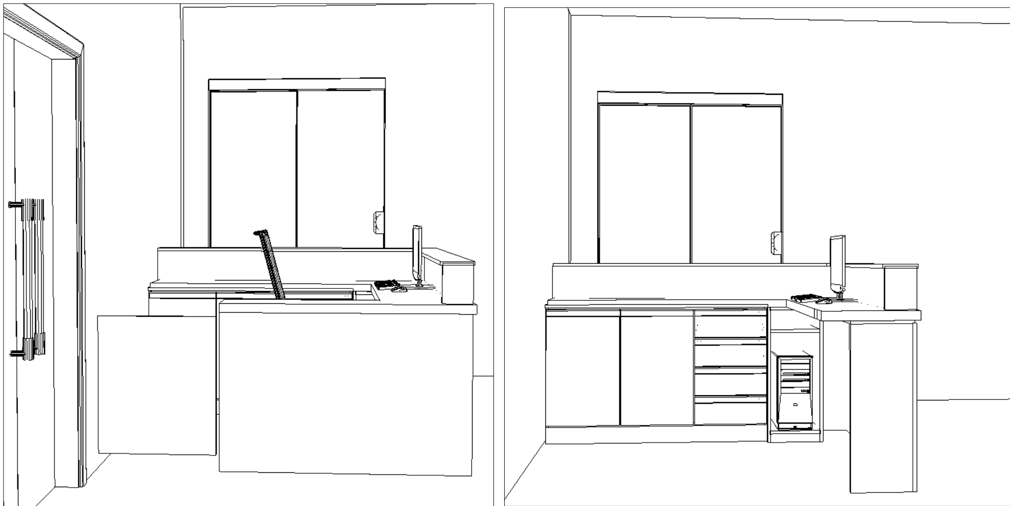
Item 1 Balcão recepção "U" em MDF Areia e Capuccino 18 mm, medindo 190x190x190, altura 1,10 (parte interna)
